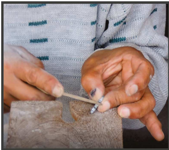
Figura 11. Pulido de la pieza mediante utilización de madera de guayacán y palo santo.
