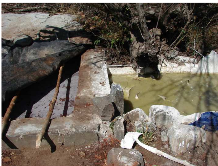
Figura 6. Puesto La Tunita. Curtido de cuero utilizando corteza de cebil, hojas de molle y cal viva.
